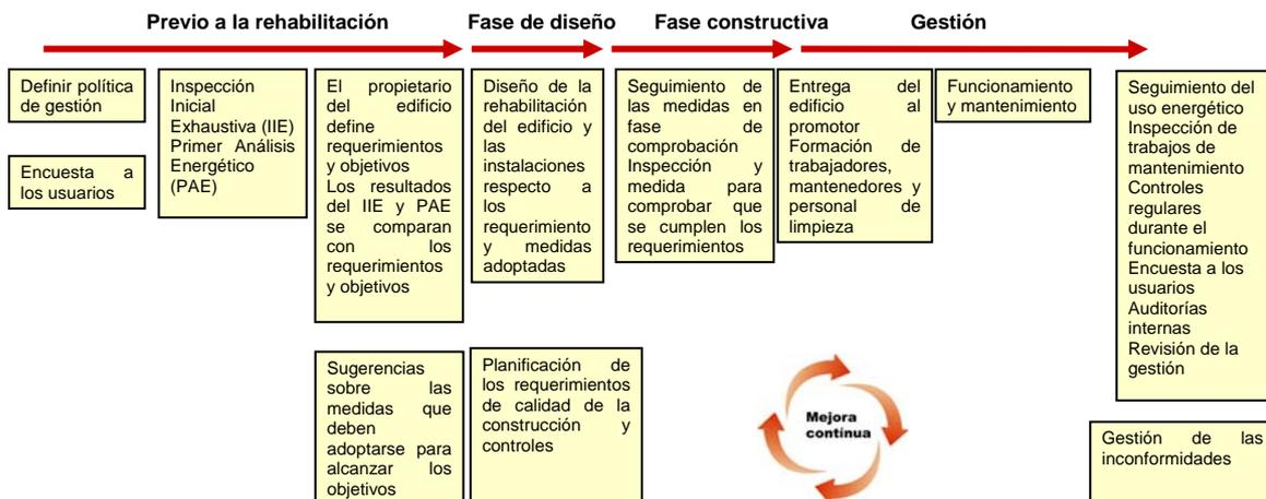
Figure 1. Sistema de garantía de calidad ambiental interior y energética adaptado al proceso de rehabilitación de vivienda social
