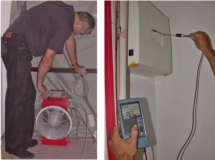
Kuva 3.17 ja 3.18 Seinän tiiveyden testaus (vaemalla). Vuoreiti jäljitetään merkkisavulla ja virtausmittarilla (oikealla)
