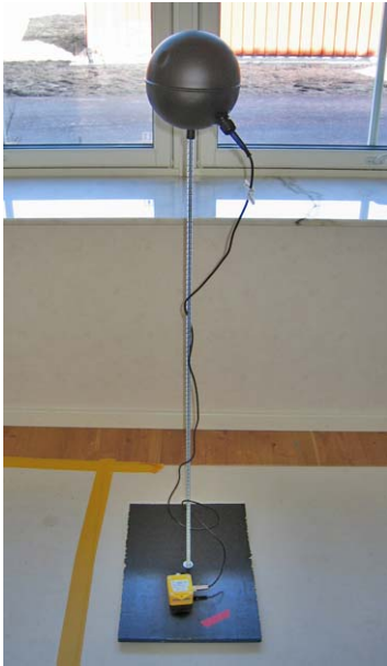
Kuva 3.9 Asumon operatiivisen lämpötilan mittaus passiivitalossa Frillesås, Sweden.
